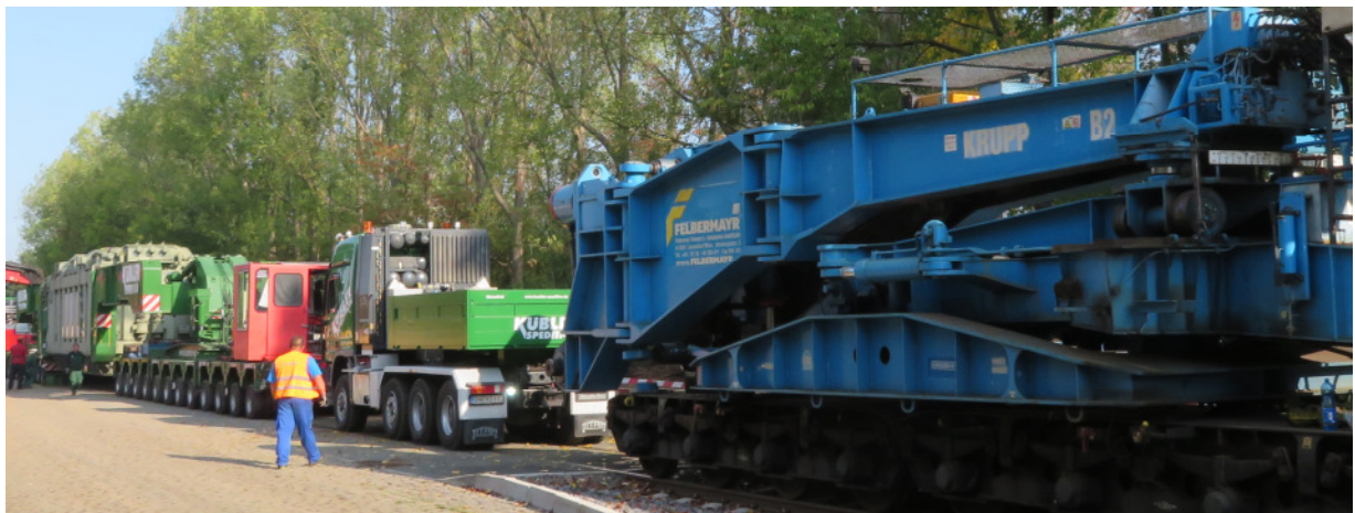
Hand in Hand: Umladung eines Transformators von ITB-Waggon auf Kübler-Tieflader
